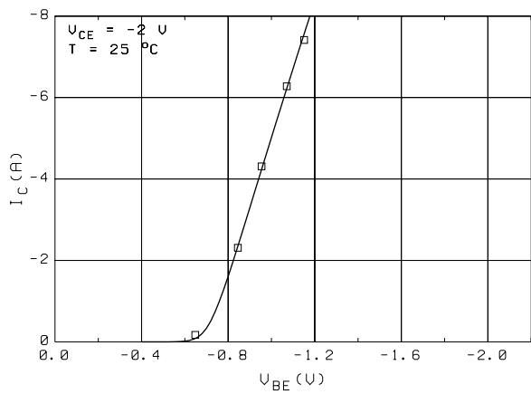
$I_C$  -  $V_{BE}$  ( $V_{CE}$ )
